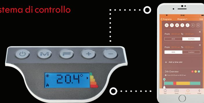
KLIMA Wi-Fi integra un display digitale per accedere manualmente alle funzioni di controllo del radiatore. Grazie a questo, il prodotto è in grado di funzionare anche in caso di assenza della rete Wi-Fi.
